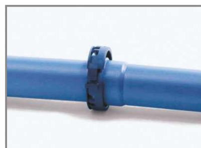
Chiudere il collare sul giunto facendo coincidere il gradino porta guarnizione del bicchiere con l'apposita scanalatura del collare
