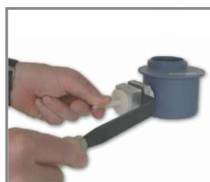
Termosaldatura a circa 200°C
