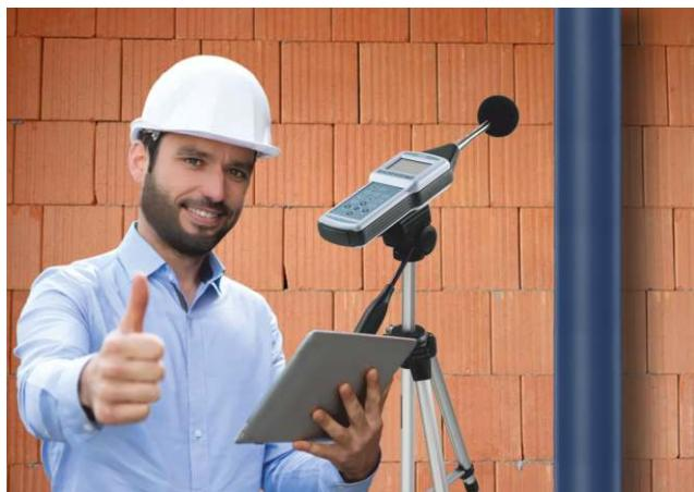
■ **Misurazione tecnica** - La soglia di 10 dB è il limite inferiore di misurazione per le apparecchiature utilizzate nei test dei sistemi di scarico. Questo non significa che un sistema di scarico non possa essere più silenzioso di 10 dB, ma che gli strumenti non riescono a misurarla con precisione.
